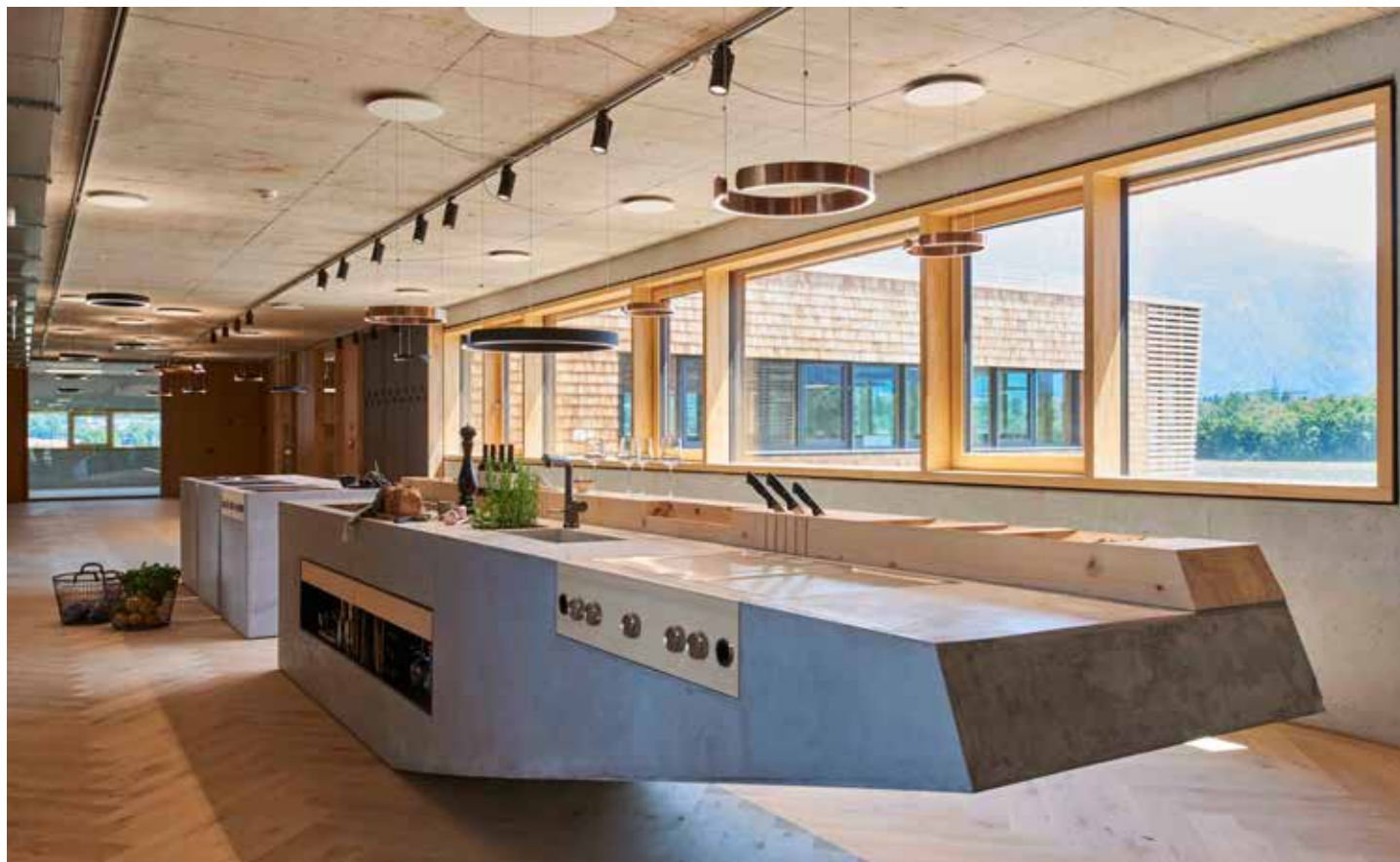
Im Showbereich des Bora Verwaltungsgebäudes wurden zum einen die LED-Pendelleuchten Mito von Occhio, als auch ein 3-Phasen-Schienensystem mit Spots von Molto Luce eingesetzt, um spannende Akzente im Raum zu kreieren.
